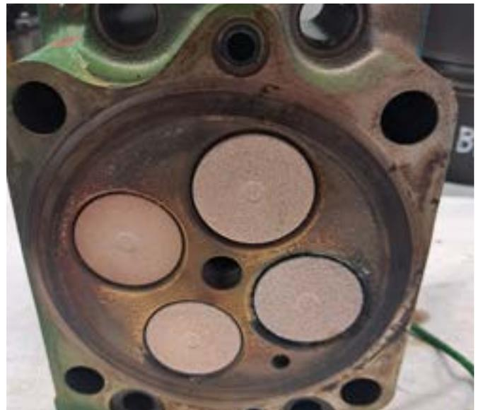
Sämtliche Werte wurden in eine Online-Datenbank eingegeben und kontinuierlich ausgewertet. Anschließend zerlegten die Techniker zwei Zylinderkopfeinheiten inklusive Kolben, Laufbuchsen und Pleuellagern, vermaßen alle Bauteile und prüften sie auf Verschleiß. Die Ergebnisse des Tests waren hervorragend: saubere Zylinderlaufflächen und Kolben sowie praktisch keine Ablagerungen an Zylinder- und Ventilköpfen. Alle Betriebs- und Verschleißparameter entsprachen den Angaben des Herstellers.
